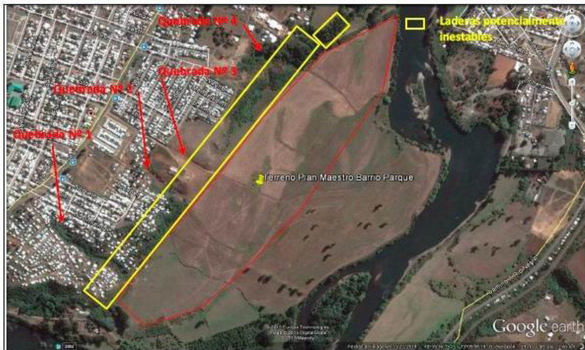
Figura N°48. Sector con un alto riesgo de inestabilidades por deslizamientos de suelo. (LEPUCV,2015) Fuente: Imagen extraída de archivos de Estudios de “Construcción Macroinfraestructura Barrio Parque Integrado de Osorno”.
